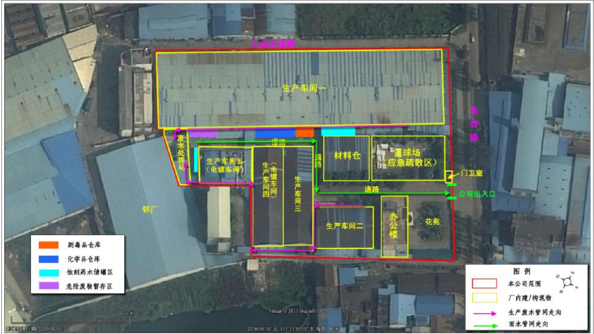
附件 4 公司生产废水、雨污管网走向图
